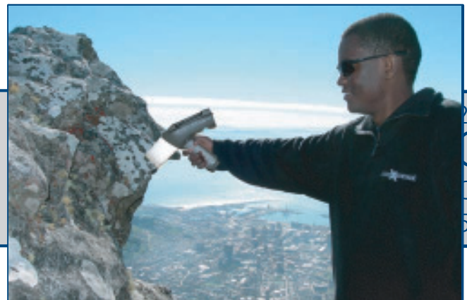
Das Alpha Series TM Analysegerät ermöglicht die Bestimmung toxischer Metalle, der im RCRA aufgeführten metallischen Bodenschadstoffe sowie sonstiger Schadstoffe in Proben verschiedenster Art.
