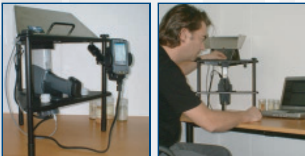
Dockingstation / Prüfstand mit Schutzabdeckung zur Analyse von eingetüteten und aufbereiteten Proben
