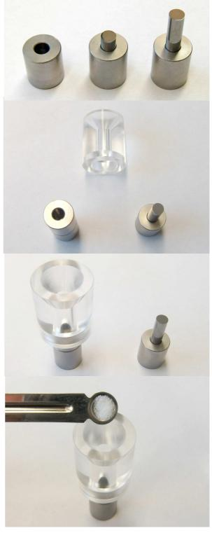
Stellen Sie jetzt das befüllte zusammengesetzte Werkzeug in die Presse. Wenn gewünscht, verwenden Sie die für Maassen-Pressen erhältliche Zentrierhilfe um das Werkzeug einfacher mittig positionieren zu können. Drücken Sie nun die Probe mit dem gewünschten Pressdruck zusammen.
